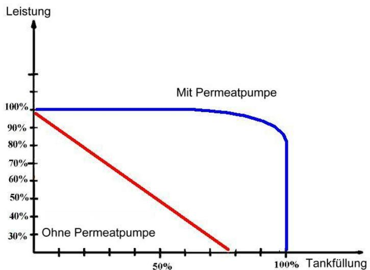
Die Pumpe wird mechanisch betrieben, sie benötigt keinen Stromanschluss oder Batterien und ist wartungsfrei. Bei einer gemeinsamen Bestellung mit einem Osmosegerät wird die Pumpe von uns eingebaut.
